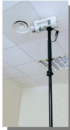
La perche télescopique permet de réaliser des prélèvements dans des endroits difficilement accessibles (gaine d'aération....).
