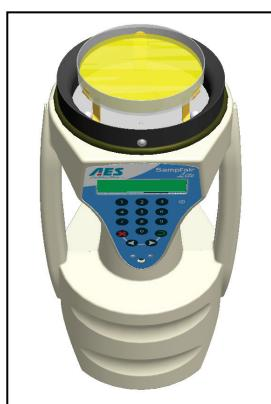
**Etape 3** Placer la boîte de Petri horizontalement sur les trois lamelles en inox situés au-dessus de l'orifice de la turbine. Ce dispositif de maintien permet de centrer la boîte de Petri par rapport à la turbine. S'assurer que la boîte est bien calée dans son logement.
