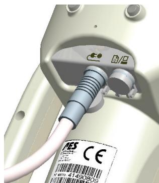
Brancher le chargeur sur le secteur (tension 100 à 240 VAC +/-10% 50-60 Hz/700mA). Le chargeur délivre une tension de 15 V cc, 2 A.
