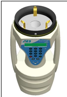
**Etape 2** Positionner le bloc de prélèvement verticalement. Oter la tête inox en tirant de bas en haut. La déposer sur une surface propre.
